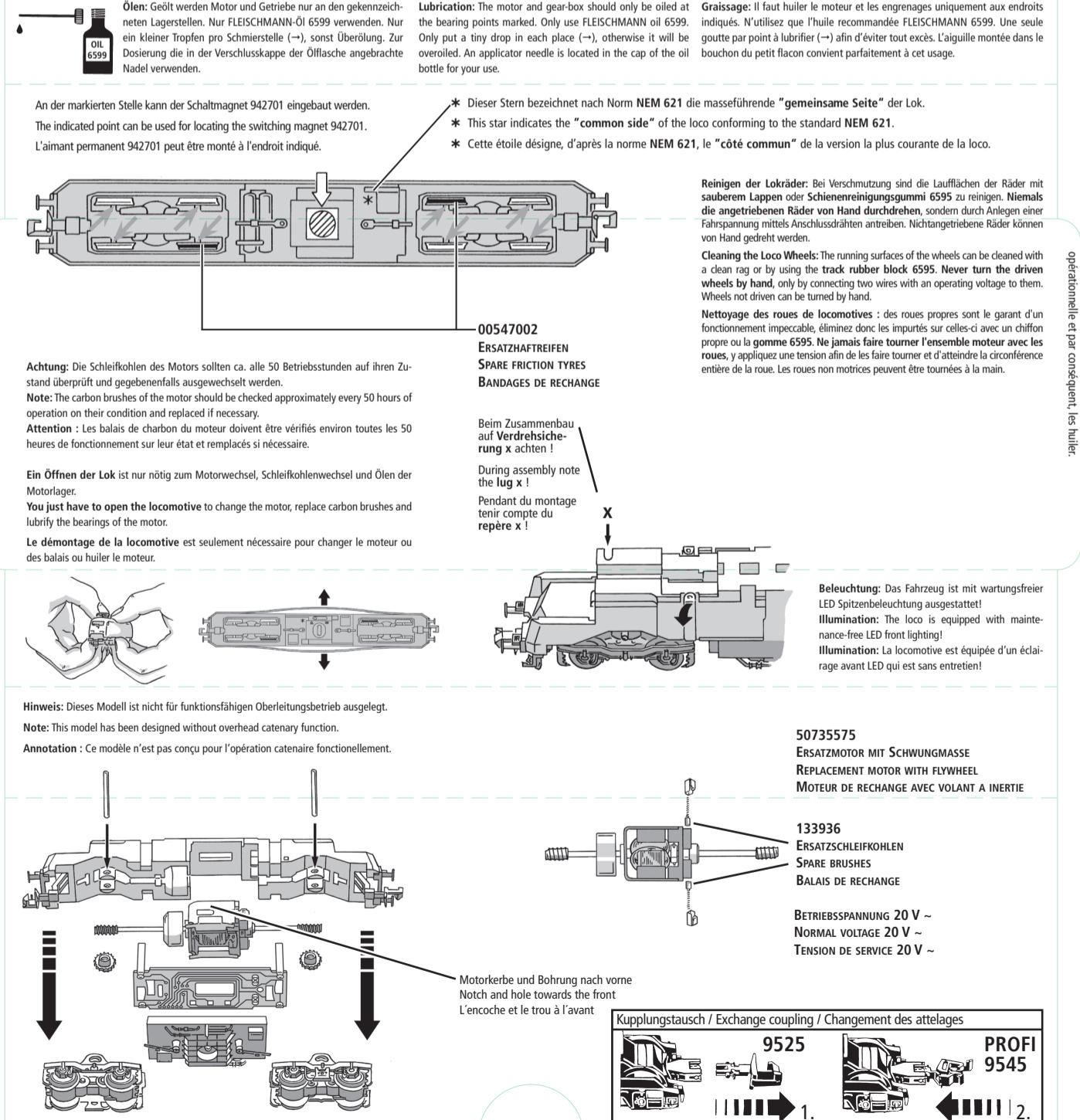
Wir empfehlen, die Schmierstellen der Lok je nach Betriebsdauer und Bedingungen zu überprüfen und ggf. zu ölen. We recommend to inspect the lubrication of the loco's bearings by hand, only by connecting two wires with an operating voltage to them. Wheels not driven can be turned by hand. Nous recommandons pour inspecter le lubrification de l'enroulement individuel, dépendent de la durée et les conditions opérationnelle et par conséquent, les huiler.
